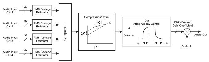
Figure 43. DRC Block Diagram
