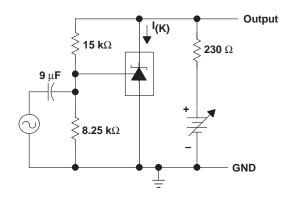
TEST CIRCUIT FOR VOLTAGE AMPLIFICATION
