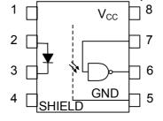
2:ANODE 3:CATHODE 4:N.C. 5:GND 6:V<sub>O</sub>(OUTPUT) 7:V<sub>E</sub>(ENABLE) 8:V<sub>CC</sub>
