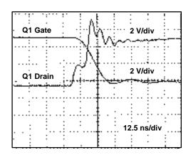
Figure 24. Q1 Turn-On Waveform
