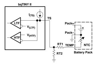
Figure 27. TS Pin Threshold
