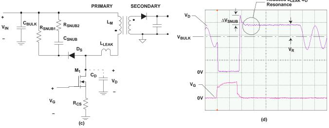
Figure 15. (a) RCD Snubber, (b) RCD Snubber Waveform, (c) R<sup>2</sup>CD Snubber, (d) R<sup>2</sup>CD Snubber Waveform
