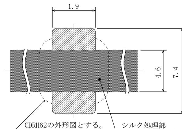
電極 (端子) 間の隙間はシルク処理をして御使用下さい。
