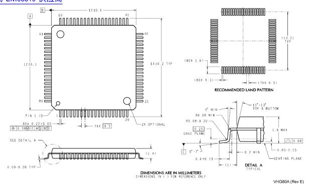
80-Lead TQFP NS Package Number VHB80A
