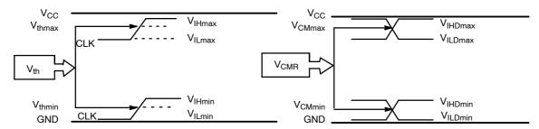
Figure 10. V<sub>th</sub> Diagram
