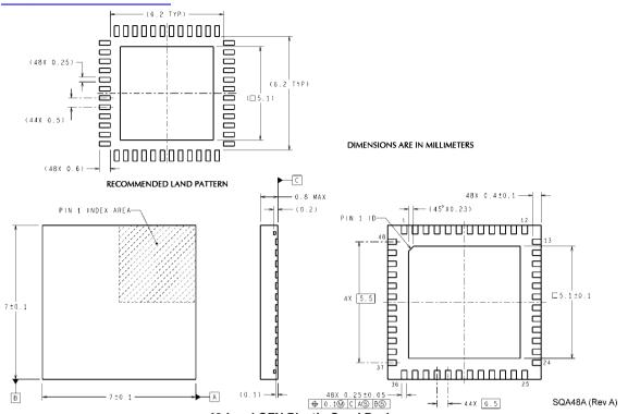
48-Lead QFN Plastic Quad Package NS Package Number SQA48A
