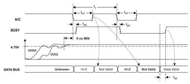
Figure 26. ADC Reset
